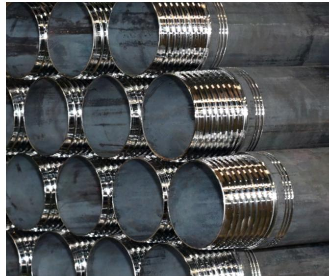
Las barras de perforación Di-Corp vienen con ranuras indicadoras grabadas en el exterior del barra para identificar rápidamente la rosca. Una ranura para la rosca R, dos ranuras para la rosca D, tres ranuras para S-Maxx (en la foto) y sin ranuras para la rosca estándar.
